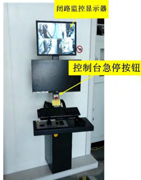
控制台急停按钮、闭路监控显示器
